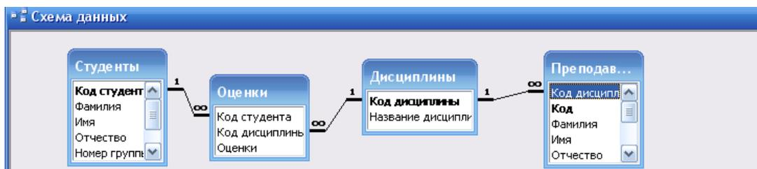
Рисунок 4. Схема данных
